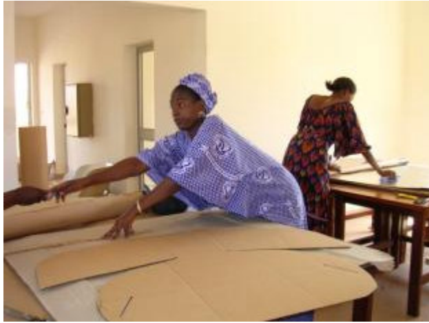
Figure 3: marquer les bandes pour coller progressivement
