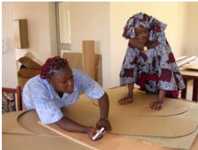
Figure 7: marquer la forme du CooKit sur le carton
