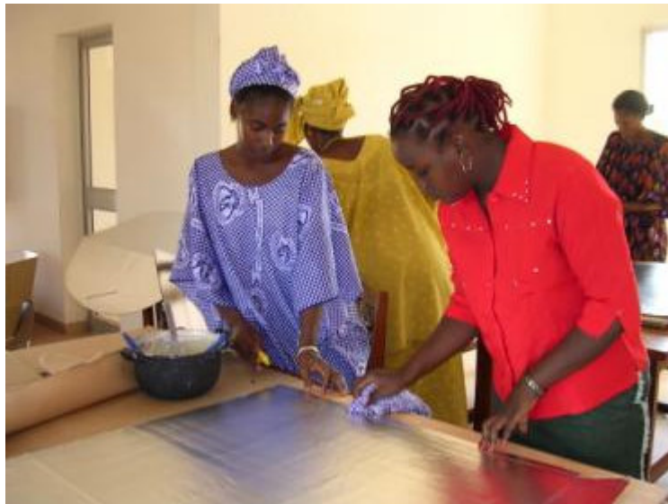
Figure 13: réparer la bande non-couvert d'alu
