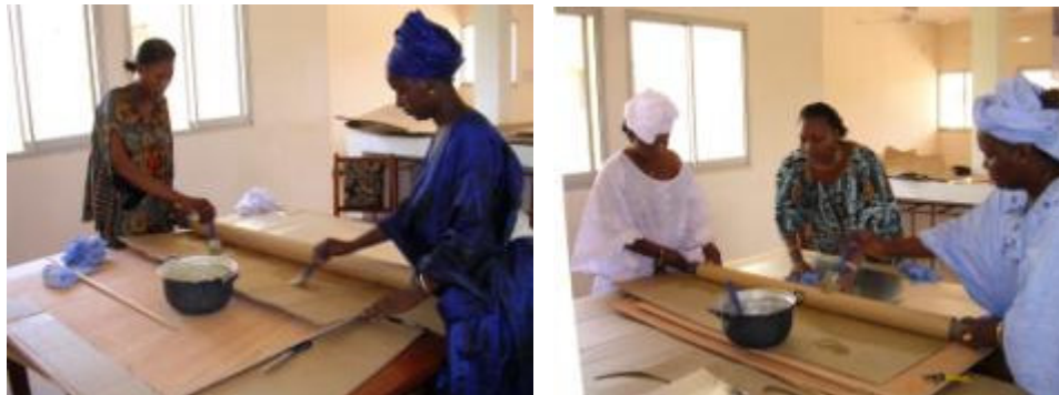
Figures 4 et 5: appliquer la colle et frotter avec un chiffon
