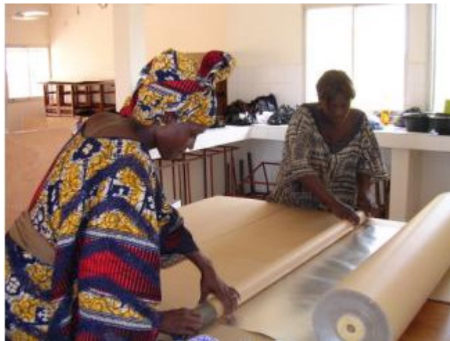
Figure 2: mettre l'alu du grand au petit rouleau
