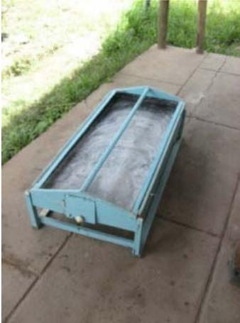
La idea es simple: utilizar el calor del sol para evaporar agua con minerales y condensar sobre una superficie más fría para coleccionar. El prototipo original (a la izquierda), fue construido por una voluntaria y produjo buenos resultados: producido agua para vender aquí en la comunidad y para alimentar los sistemas del centro solar y del restaurante de la cooperativa de los mujeres solares.
